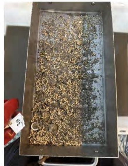
Figur 4: Bilder fra B-undersøkelsen som viser prøver som består av sand og skjellsand. Bildene til vestre er før vasking og til høyre etter vasking i sil med hullstørrelse på 1 mm (Åkerblå 2023a).
