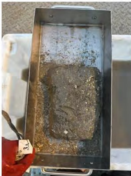
Figur 4: Bilder fra B-undersøkelsen som viser prøver som består av sand og skjellsand. Bildene til vestre er før vasking og til høyre etter vasking i sil med hullstørrelse på 1 mm (Åkerblå 2023a).
